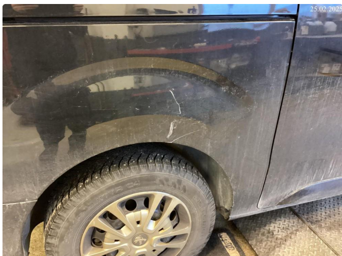
1.1 Parkerings riper på skjerm høyre bak
