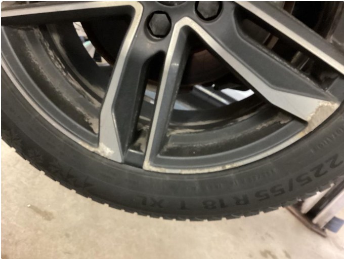
1.1 Noe kantkjørt felg på høyre side bak, vinterfelger
