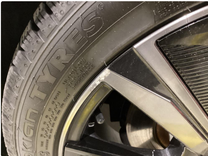
1.1 Noe kantkjørte felger
