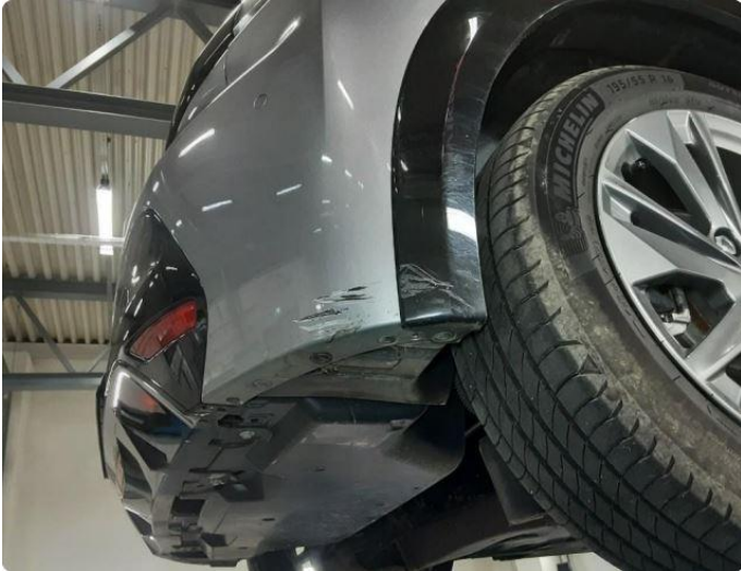
1.1 Lakk av bakfanger høyre hjørne
