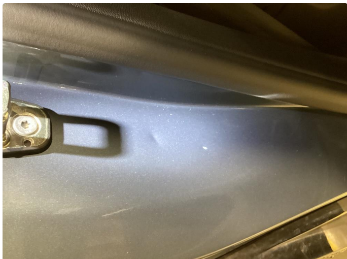
1.1 Noe små riper og bulker i døråpning
