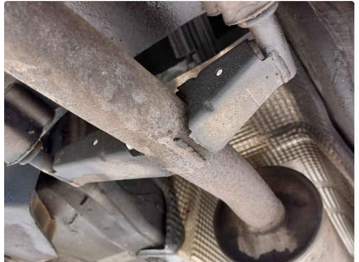
2.2 Eksosrør innfestning defekt/mangler
