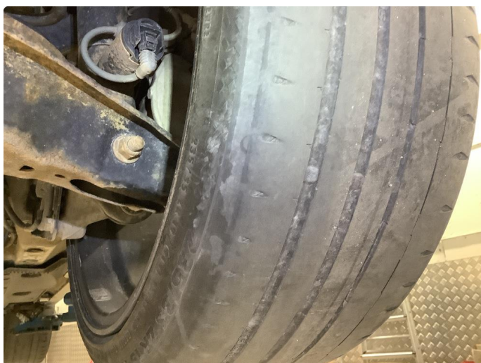
1.3 Skjev slitasje på sommerdekk
