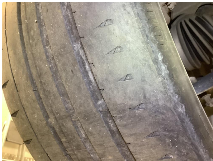
1.3 Skjev slitasje på sommerdekk
