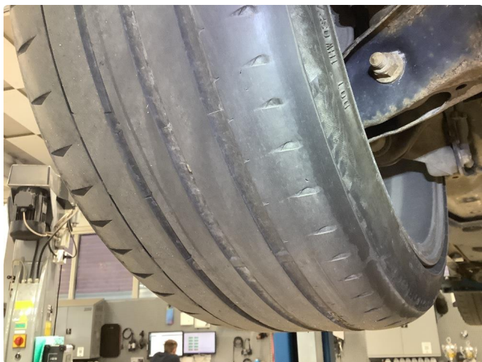
1.3 Skjev slitasje på sommerdekk
