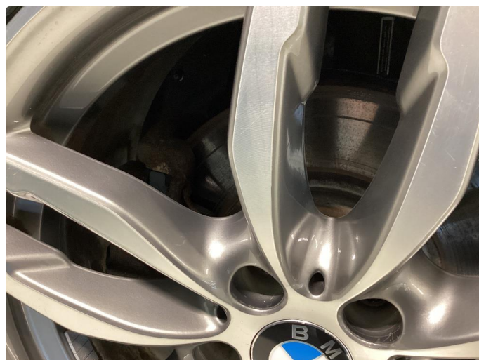
3.1 Ripe i høyre bremseskive fremre Aksel - utbedring ikke nødvendig på dette tidspunkt
