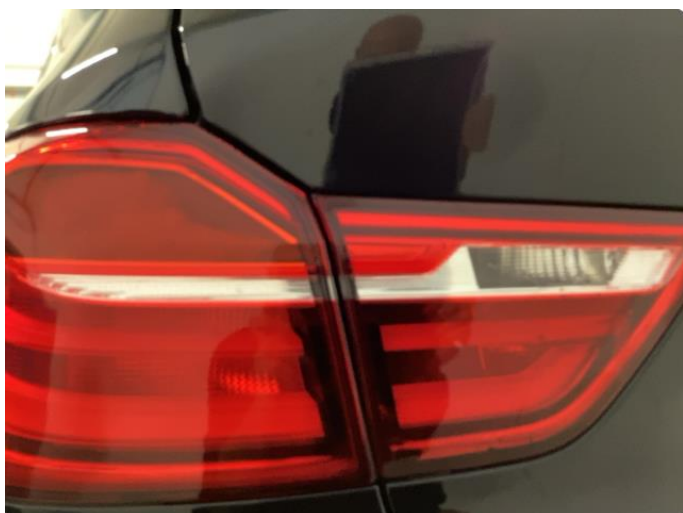
2.1 Fukt i ytre og indre baklampe v side Indre lykt har sprekk i glass
