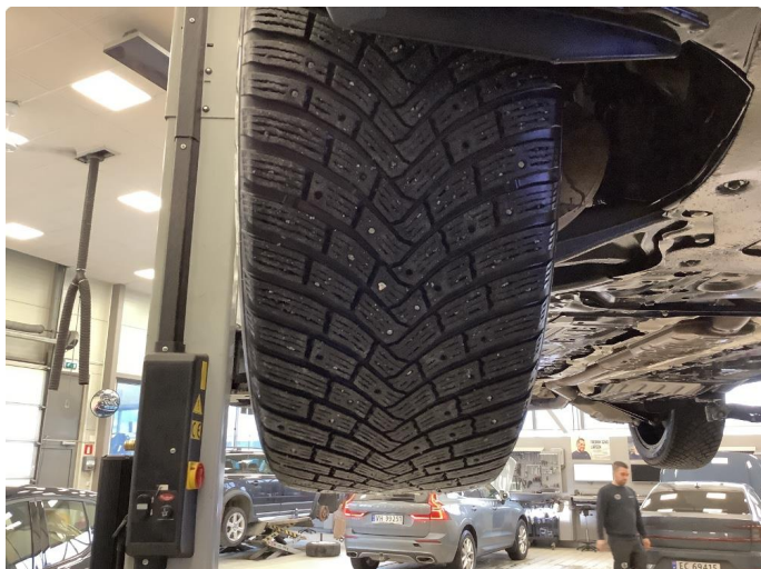
1.3 Piggdekk mangler noen pigger
