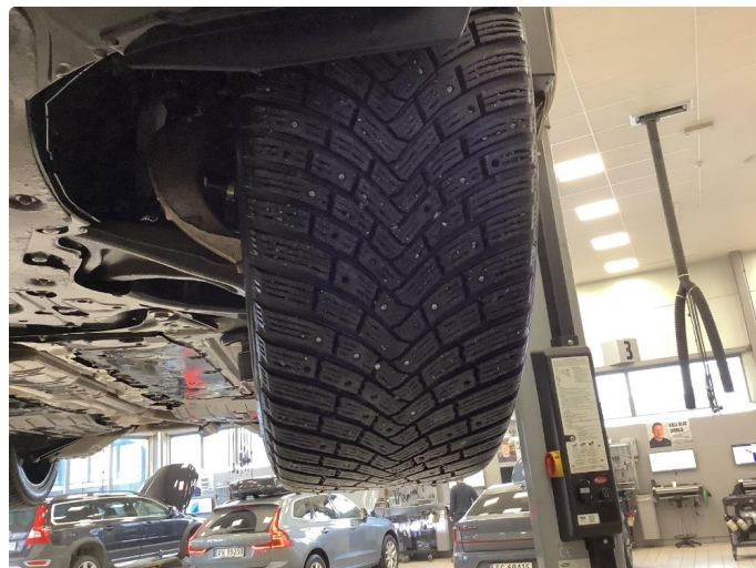
1.3 Piggdekk mangler noen pigger
