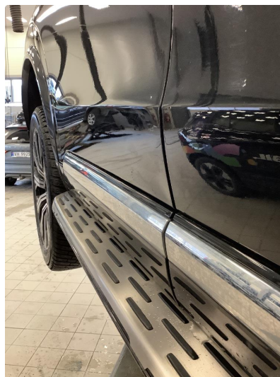
1.2 P-bulk i bedre kant av høyre bakdør
