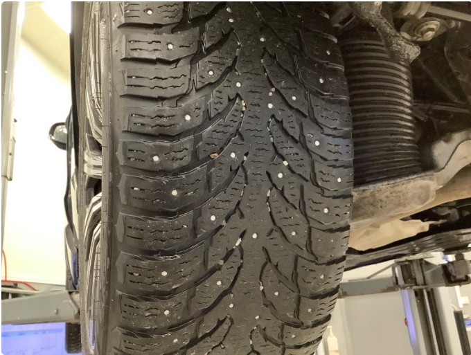
1.1 Piggdekk mangler noen pigger
