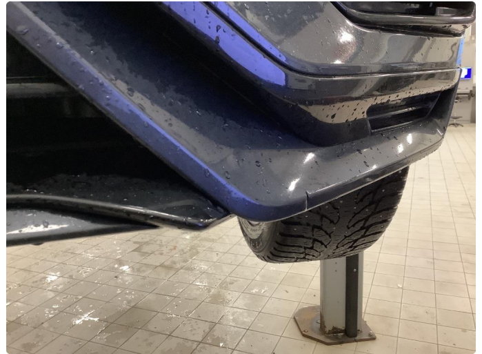
1.2 Lite hakk i nedre del på framfanger
