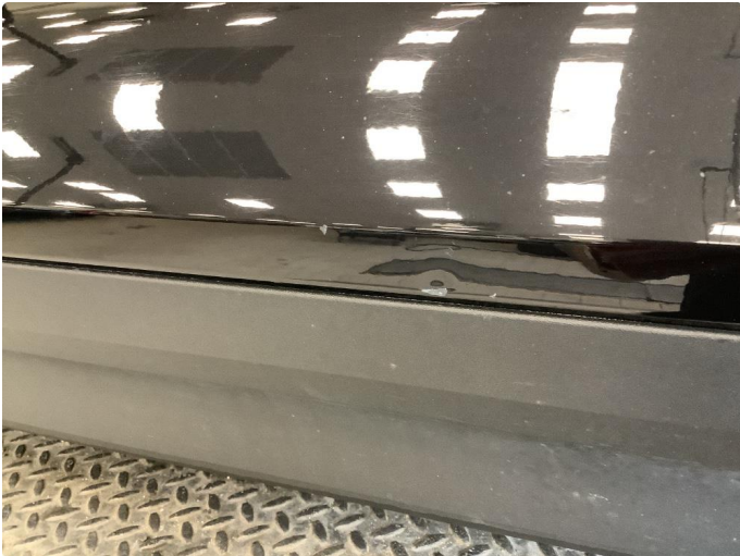
1.1 Liten p-bulk høyre framdør
