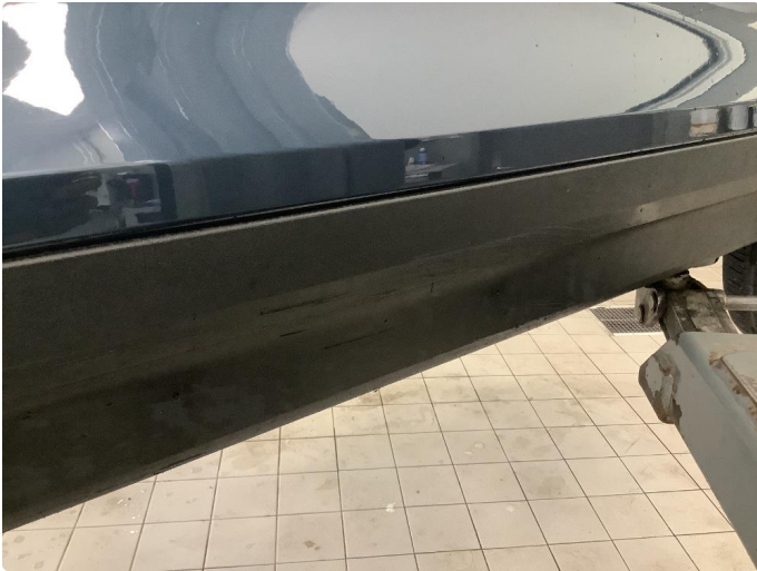
1.1 Noen merker på dørlister høyre side
