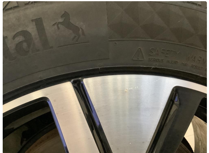
1.2 Veldig lite hakk på en felg
