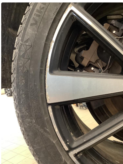
1.1 Liten skade på 2 vinterfelger
