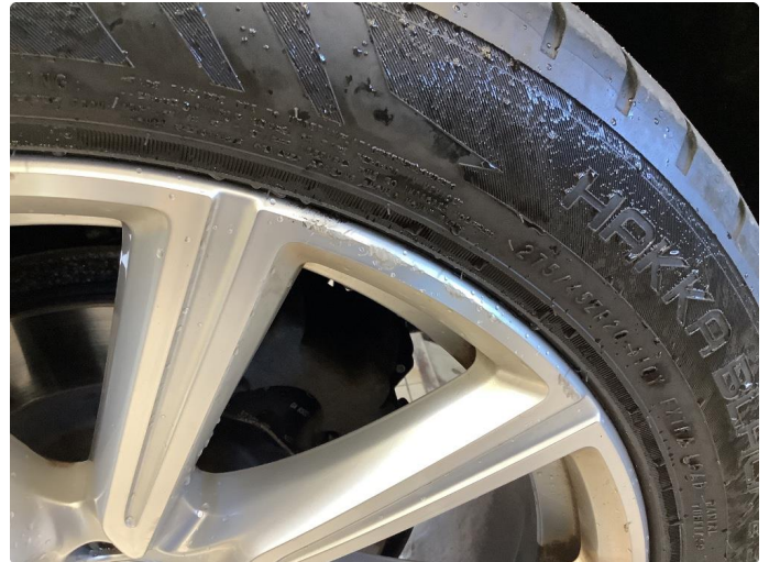
1.1 Små bruksmerker på en felg
