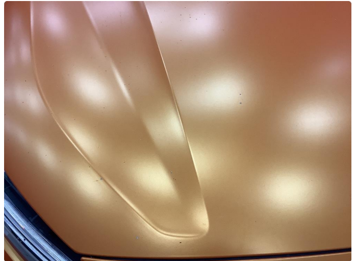
1.1 Noe slitasje på folie.
