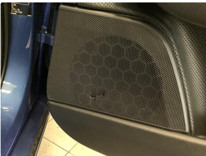
2.1 Liten sprekk i høytalerdeksel høyre bakdør
