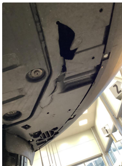
1.2 Litt sprukket plastikk under støtfanger foran
