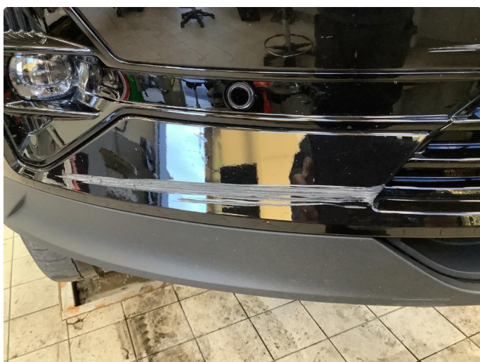
1.2 Litt sprukket plastikk under støtfanger foran
