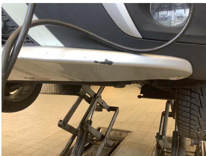
1.4 Noe skrubbskader underkant
