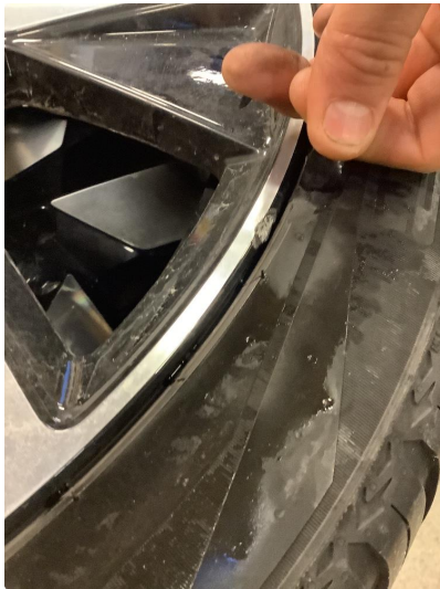
1.2 Lite bruksmerke på en sommer felg og en liten flenge ytterst i dekk som ikke har betydning
