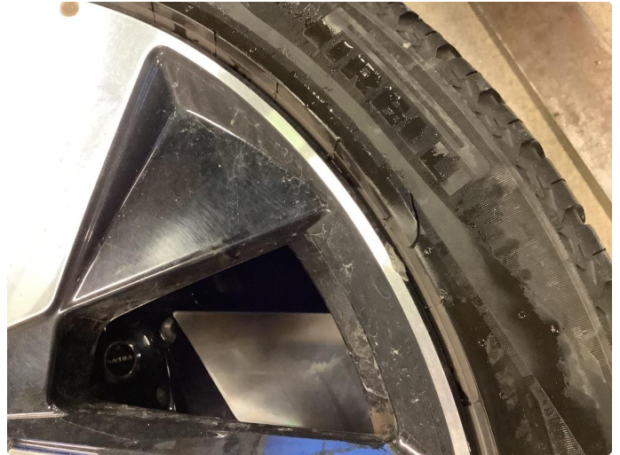
1.2 Lite bruksmerke på en sommer felg og en liten flenge ytterst i dekk som ikke har betydning
