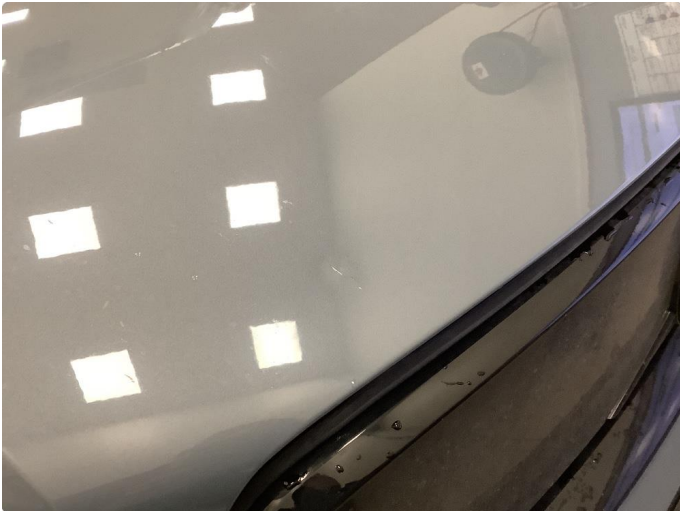
1.1 Liten steinsprut på panser.
