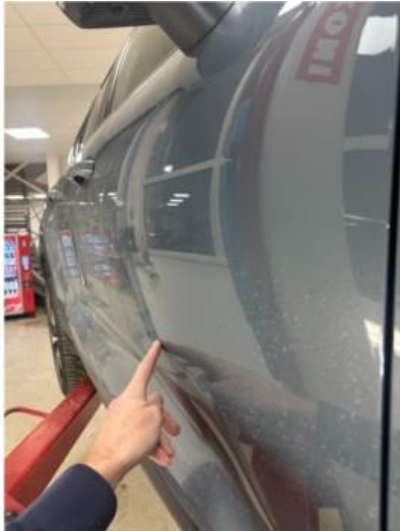
1.1 Liten bulk i dør høyre foran
