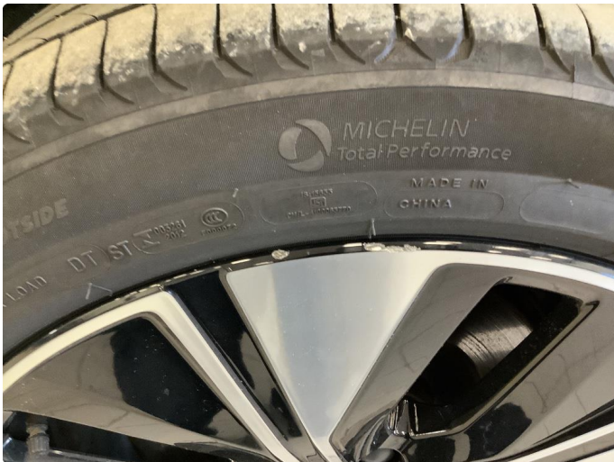
2.1 Noen mindre skader på 1 sommerfelg
