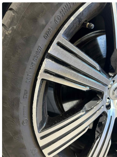
1.1 Kantkjørt felg Diamond Cut
