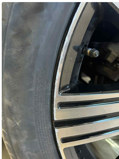
1.1 Kantkjørt felg Diamond Cut
