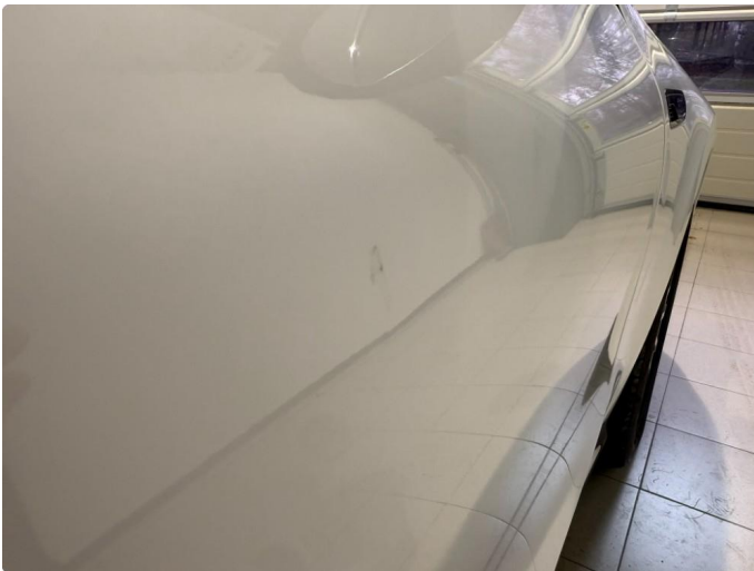
1.3 Liten bulk i dør på passasjerside, foran.
