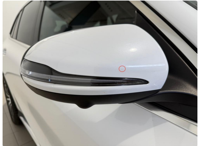
1.2 Liten steinsprut på sidespeil passasjerside (se inni rød sirkel)
