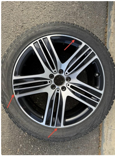
1.7 Ene vinterhjulet er litt kantkjørt (se piler på bildet)
