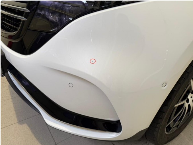
1.1 Liten steinsprut på venstre side av frontfanger (se inni rød sirkel)
