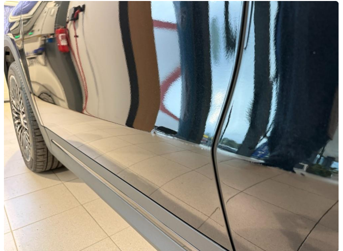
1.2 Småbulker på førerdør
