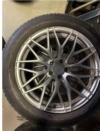
1.2 Et av vinterhjulene er noe kantkjørt.
