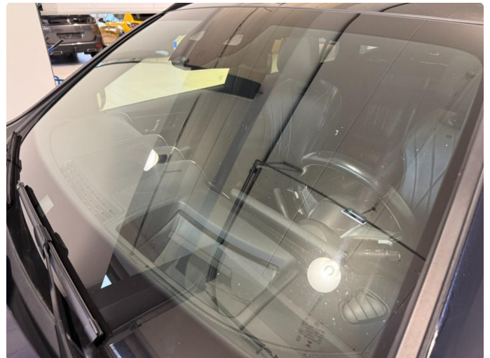
1.4 Noe slitt frontrute av steinsprut, men ingen større steinsprut eller sprekker.
