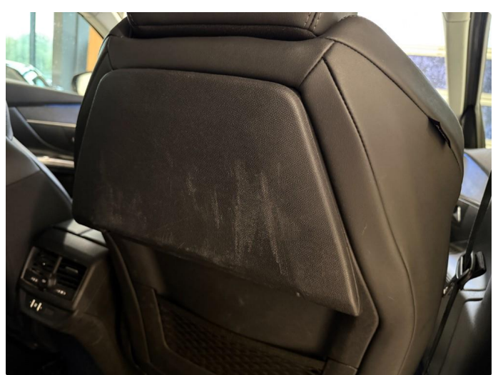
2.2 Slitasje på "flybrett"
