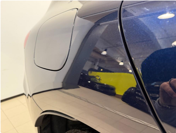
1.1 Liten parkeringsbulk ved ladeluke
