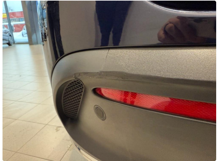
1.2 Ripe og sprekk i plastikk på bakfanger
