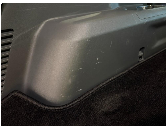
2.2 Riper på plastikk i varerom
