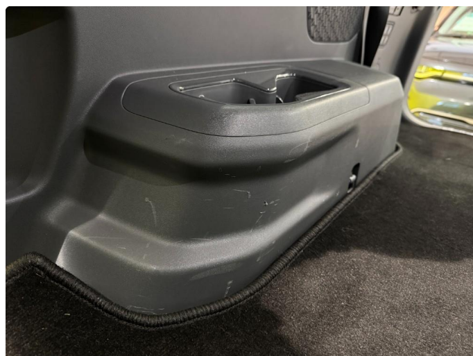
2.1 Riper på plastikk i varerom
