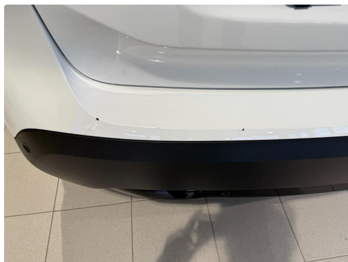
1.3 Slitasje på innlastningssone ved bakluke
