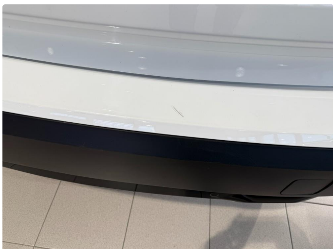
1.3 Slitasje på innlastningssone ved bakluke
