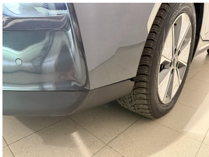
1.4 Liten sprekk i list på frontfanger førerside
