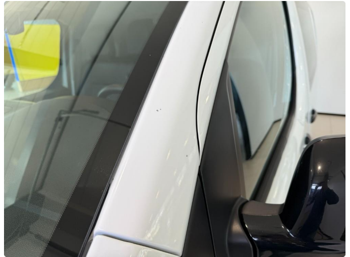
1.2 3 små steinsprut på A-stolpe
