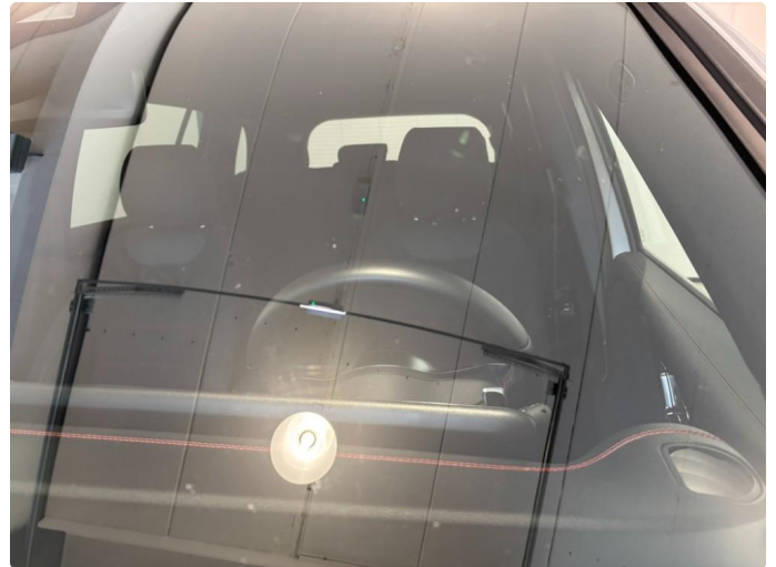
1.2 Små steinsprut i ytterlaget på ruta
