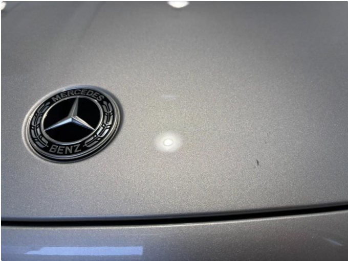
1.1 Litt steinsprut på panser
