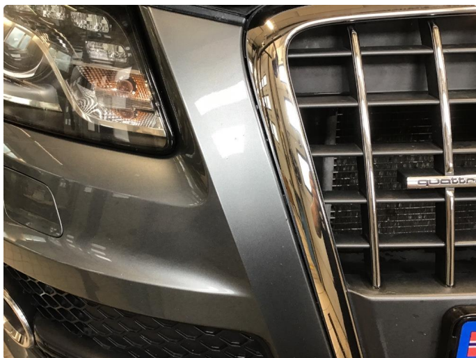
1.4 Noe steinsprut på støtfanger foran
