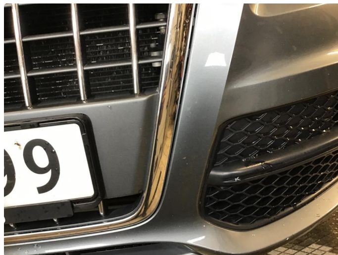
1.4 Noe steinsprut på støtfanger foran
