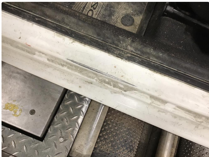
1.3 Slitt gjennom lakk
