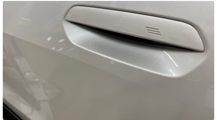
1.1 Noe bruks slitasje lakk - Utbedret med lakkstift 12.12 EK
