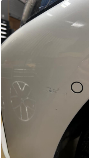
1.1 Noe bruks slitasje lakk - Utbedret med lakkstift 12.12 EK
