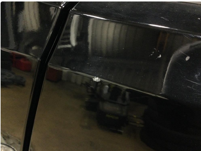
1.2 Skade - 06.11.25 EK - Utbedret med lakkstift.
