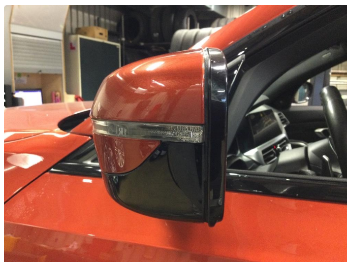
1.3 Blinklys defekt/fukt - 21.11.25 EK - Byttet til ny
