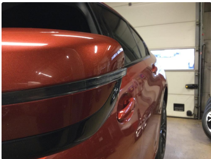
1.3 Blinklys defekt/fukt - 21.11.25 EK - Byttet til ny
