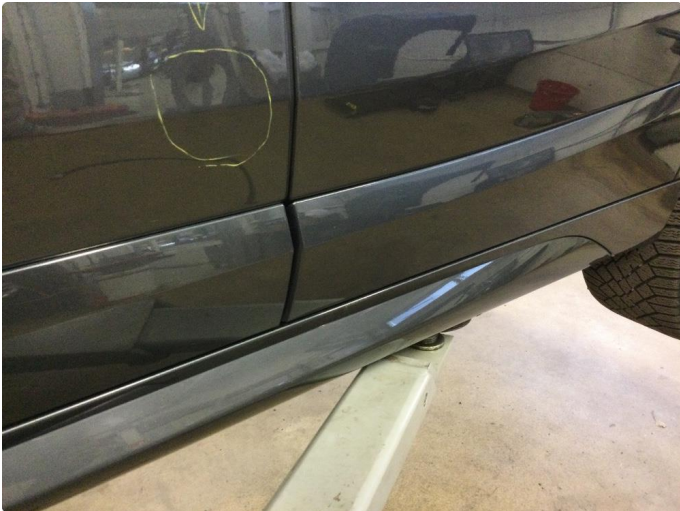
1.1 Park bulk på dør. Er utbedret- ok
