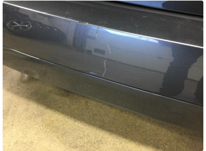
1.2 Riper støtfanger bak v/innlasting. OK
