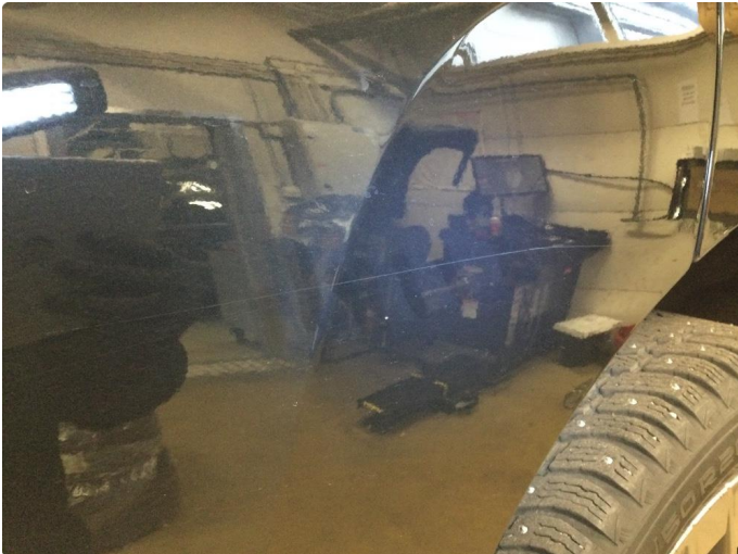
1.1 Riper - Utbedret med lakkrens 13.11.2025 EK
