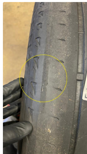
1.1 For liten mønsterdybde sommerdekk - 10.06.2026 EK - Byttet 4 dekk.
