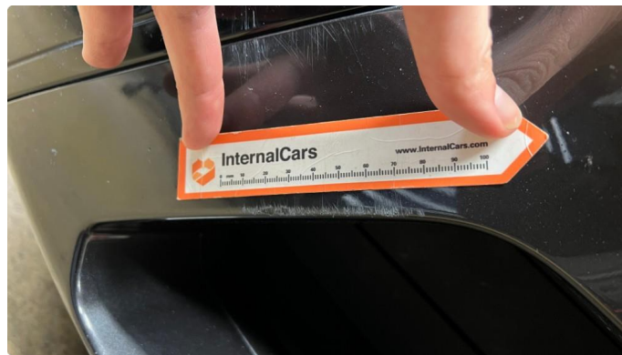
1.2 Skade - 10.06.2026 EK - Utbedret med lakkrens, synlige små skader.
