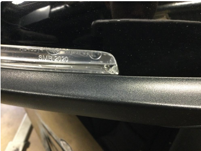
2.1 Krakelering i plast - 03.11 EK - Minimalt krakkelering, ingen lekkasje.
