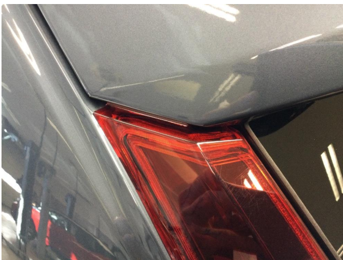
2.1 Krakelering i plast - 29.12 Litt krakkelering, men ingen lekkasjer.
