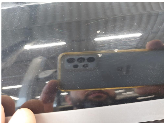
1.4 Steinsprut - 11.05.26 EK - Utbedret med lakkstift
