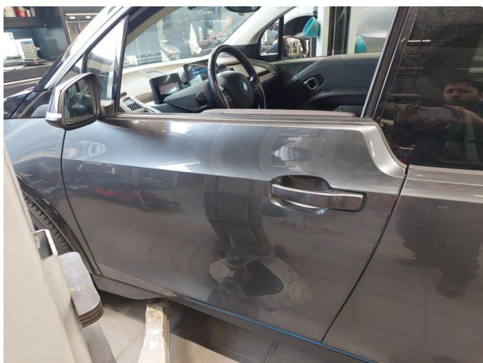
1.2 Riper - 11.05.26 EK - Utbedret med lakkrens
