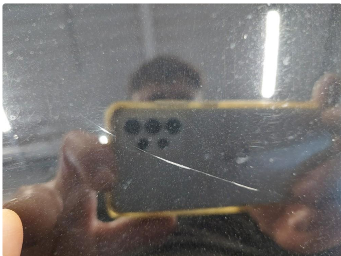
1.1 Steinsprut - 11.05.26 EK - Utbedret med lakkstift
