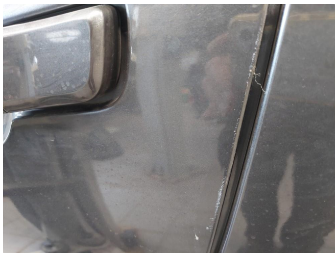
1.2 Riper - 11.05.26 EK - Utbedret med lakkrens
