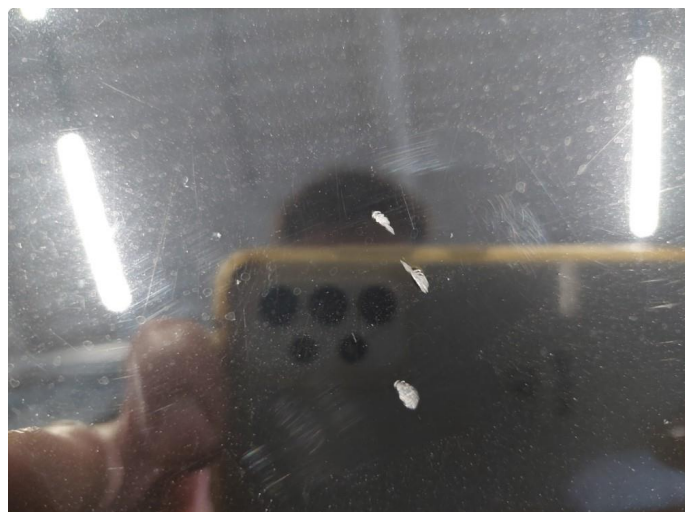
1.1 Steinsprut - 11.05.26 EK - Utbedret med lakkstift
