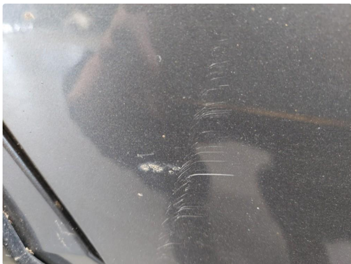
1.2 Riper - 11.05.26 EK - Utbedret med lakkrens
