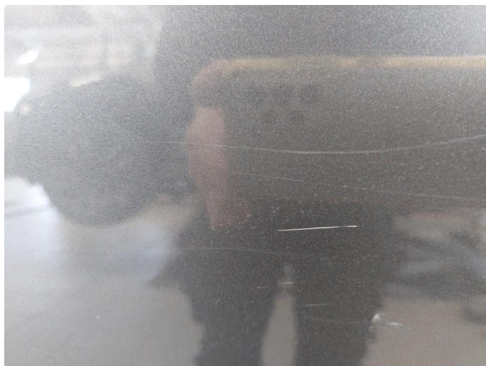
1.2 Riper - 11.05.26 EK - Utbedret med lakkrens
