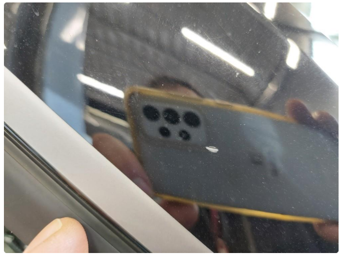
1.5 Stensprut - 11.05.26 EK - Utbedret med lakkstift
