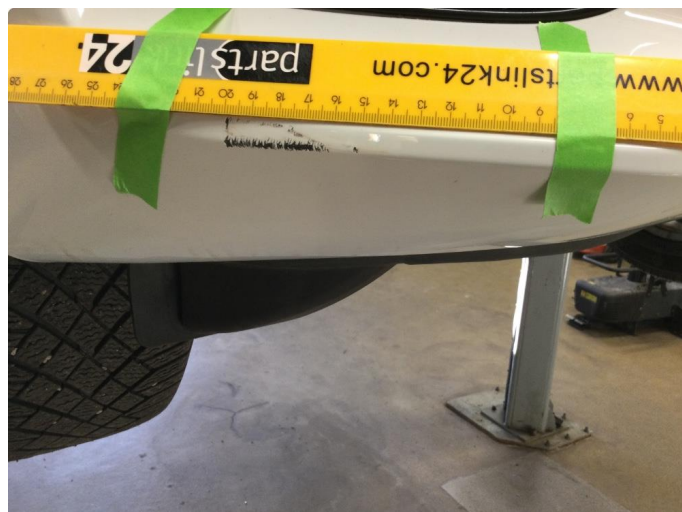
1.2 Ripe er utbedret med lakkering
