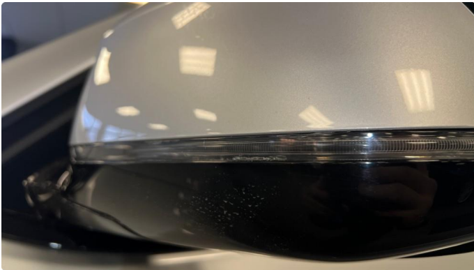
1.1 Blinklys sprukket/krakelert - 26.02.26 EK - Blir byttet 26.02
