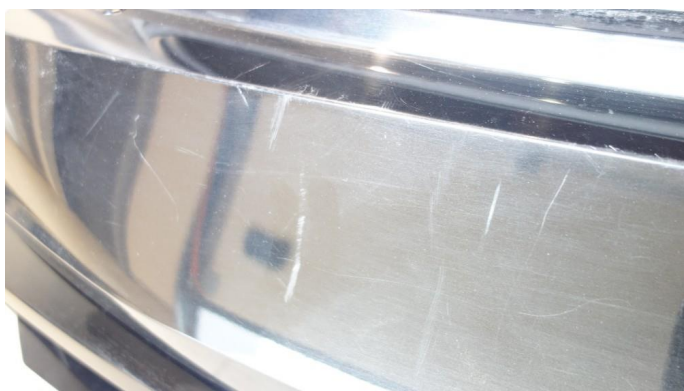
1.2 Skade - 11.06.2026 EK - Utbedret med lakkrens, små riper igjen
