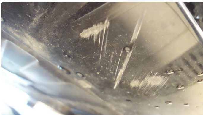
1.3 Skrubbskader underkant - 11.06.2026 EK - Små skrubbskader, men ingen defekt merker.
