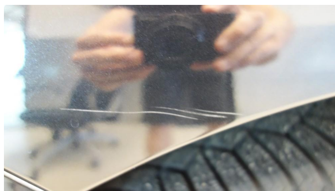
1.1 Generelt mye riper - 11.06.2026 EK - Utbedret med lakkrens
