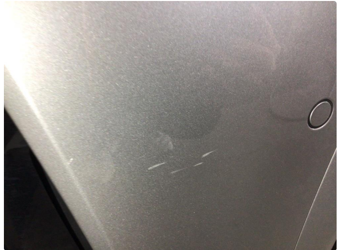
1.2 Ripe/lakk (halv del) - 25-02-26 EK utbedret med lakkstift/polering
