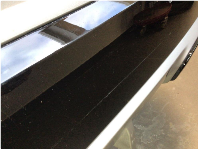
1.1 Ripe(r) ned til grunning - 25-02-26 EK utbedret med lakkstift/polering
